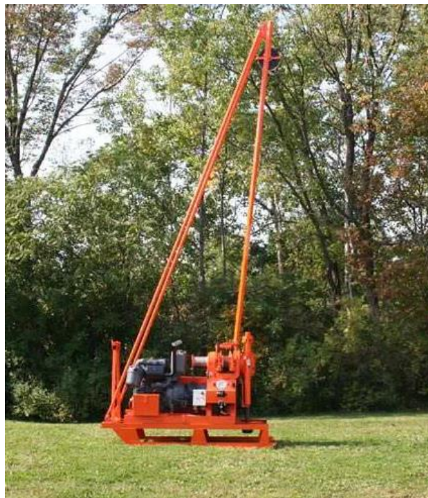
Ilustración 6. Esquema de equipo usado para la exploración usando máquina de rotación.
