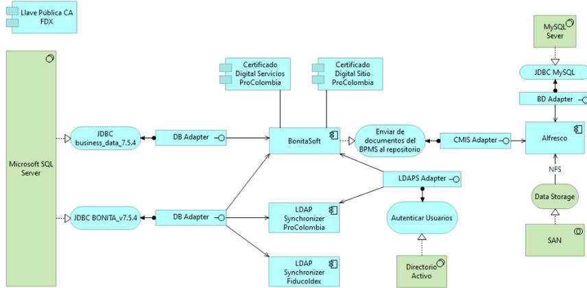
Figura 2. Diagrama de Componentes de Gestor Pro
