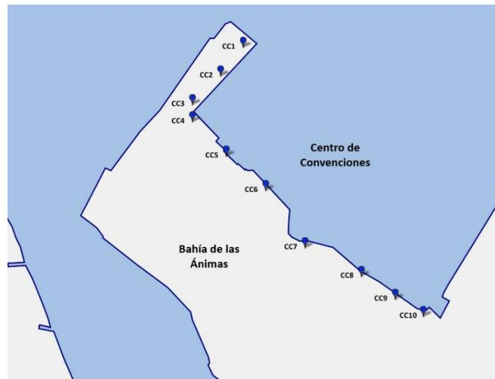
**Figura 34.** Boyas virtuales para registrar parámetros del oleaje largo del borde costero del Centro de Convenciones.
