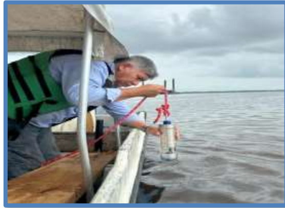
Ilustración N°30. Toma de Perfil SVP
