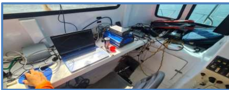
Ilustración N°14. Disposición del sistema multihaz a bordo de la embarcación.
