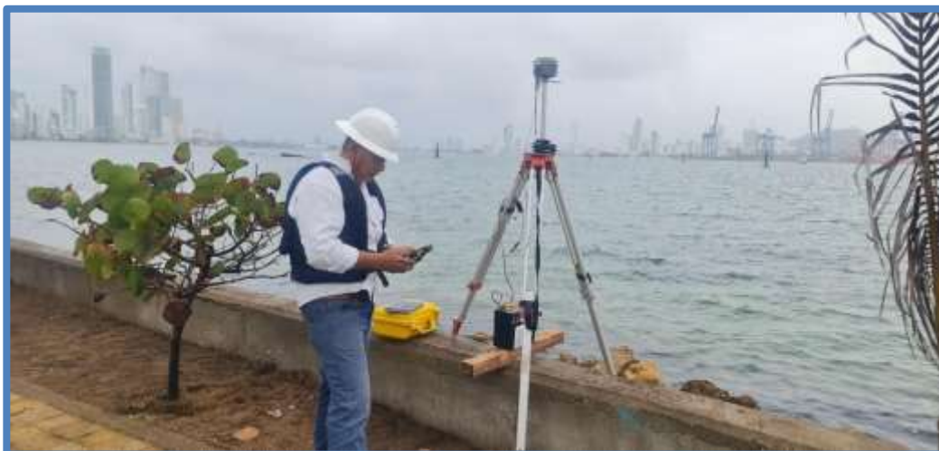
Ilustración N°17. Base RTK CP-05-11 Dimar.
